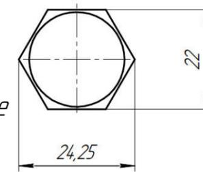
Болт/крышка для закрепления крыльчатки на электродвигателе 5АИ 63 А4 ТР У1 ИМ3281
